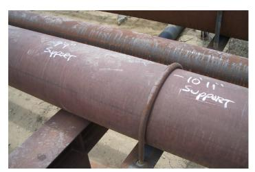
La técnica de Ondas Guiadas permite la inspección bajo soportes simples o tipo abrazadera.
