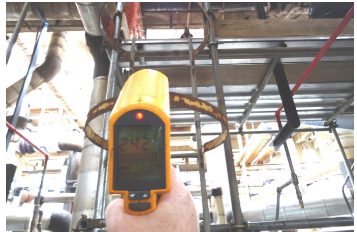
Lectura de la temperatura superficial de la línea de diésel de 8" indicando 242°C (468°F).
